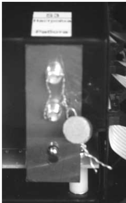
Рис.3. Пломбировка тумблера «Настройка/Работа» блока управления
